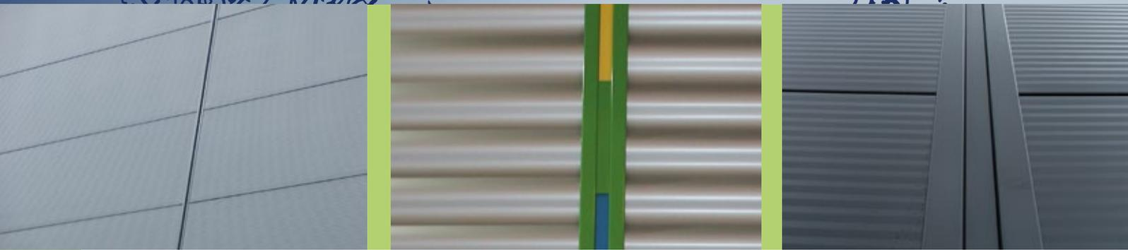
Unsere Lisene zeichnen sich durch einfache Montage aus und sind in zwei Varianten mit jeweils zwei unterschiedlichen Abdeckleisten lieferbar. Es handelt sich um Aluminium-Strangpressprofile aus dem Material EN AW-6060 T66 EN 755-9. Die Lieferlänge beträgt 6.000 mm. Die Mindestabnahmemenge beträgt 84 Laufmeter.
